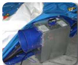
Gebälse mit Luftöffnung zum Absaugen der Luft an den Luftablass stellen.
